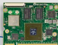
VAR-SOM-MX6 NXP i.MX6 4x 1.2GHz Cortex-A9
