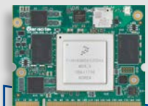
VAR-SOM-MX8 NXP i.MX8 2x 1.8GHz Cortex-A72 + 4x 1.2GHz Cortex-A53
