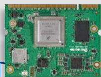
VAR-SOM-MX8X NXP i.MX8X 4x 1.2GHz Cortex-A35
